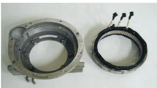
Slika 3: Kućište zamašnjaka motora SUS i stator utisnutog motor/generatora s trofaznim namotajima
